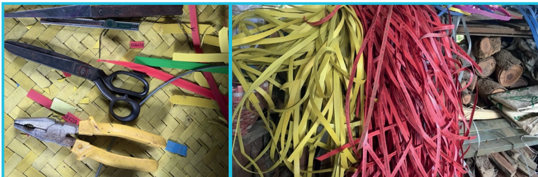
1.1 อุปกรณ์ที่ใช้ในการจักสาน ได้แก่ คีม กรรไกร คัดเตอร์ มีดและเชือกพลาสติก(วัสดุเหลือใช้)
